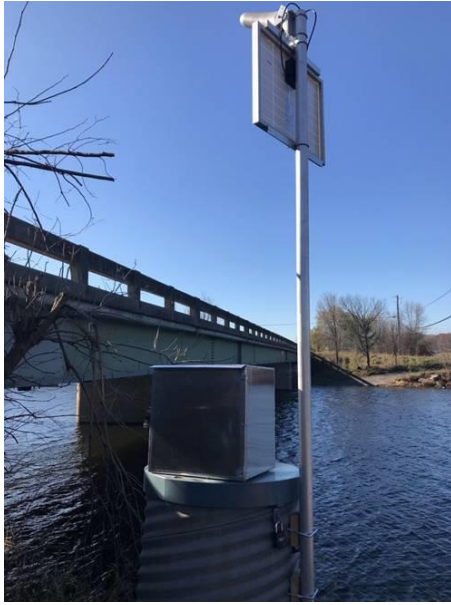
Quelques-unes des jauges de niveau du lac qui ont été installées dans la région de Quinte
